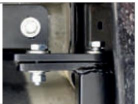
**ШАГ 5.** Затяните все резьбовые соединения. Закрепите кронштейн розетки гайкой M10 через шайбу и шайбу 10 гроверную. Установите съёмный шар в сборе и закрепите его пальцем гнутым со сплинтом. Зафиксируйте съёмный шар винтом M10x20 снизу. Затяните шар с помощью ключа рожкового или головки на 38мм.
